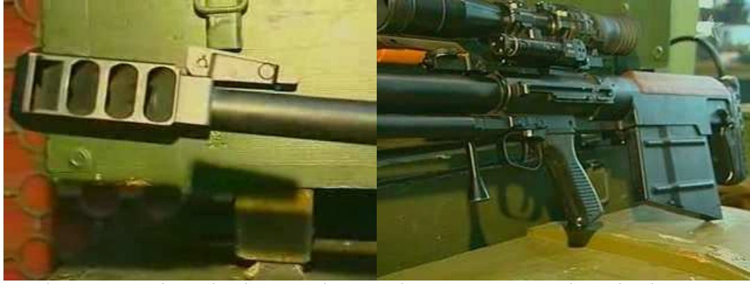
هذه صورة على اليمين لكيفية تركيب خزان الذخيرة والصورة على اليسار لفوهة اخراج الضغط.
