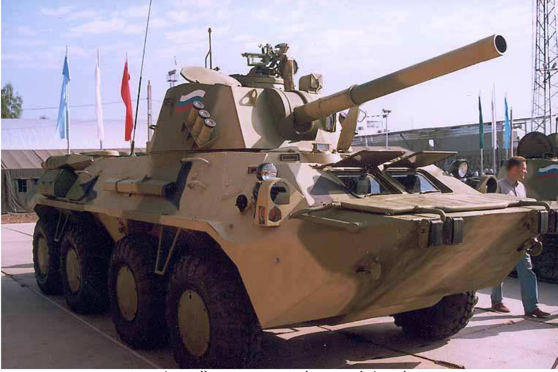
هذه النسخة المركب عليها مدفع 120مم للمدفعية (نونا)
