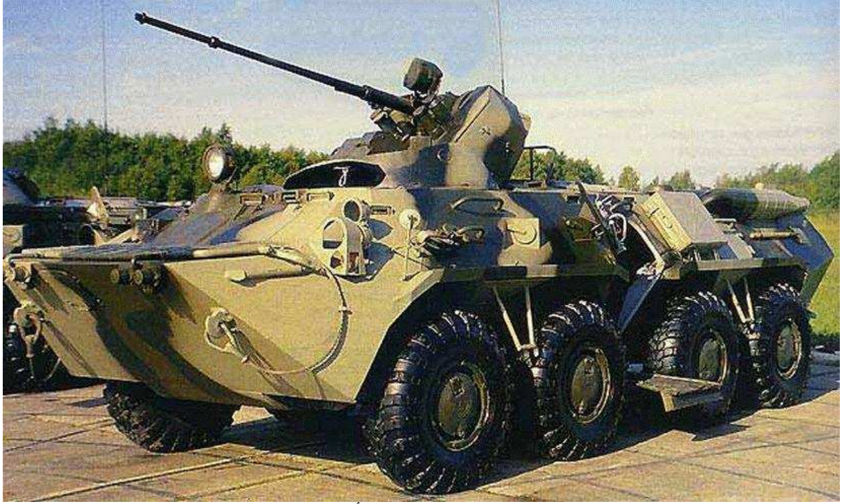
هذه النسخة الروسية المسماة (ب/ت-ر-80 أ/) مزودة بمدفع من عيار 30مم
